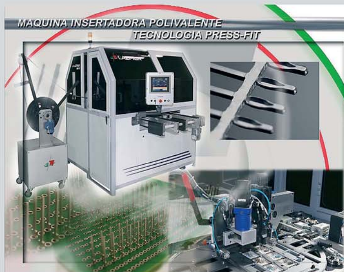
Máquina insertadora polivalente (MIPV) Press-fit con motores lineales y visión artificial
