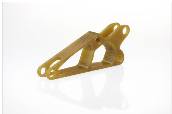
Soporte realizado en Antero 800NA (PEKK) que se emplea para montar componentes hidráulicos en el ala de un avión. Sustituye a la pieza de PEEK mecanizada y elimina el desperdicio de material propio del proceso de sustracción
