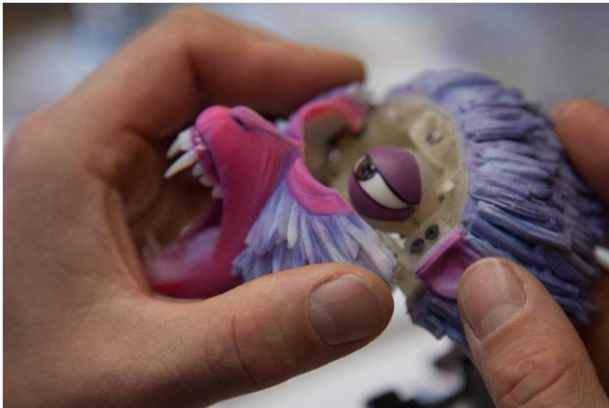
Para la película «Kubo y las dos cuerdas mágicas», LAIKA utilizó la impresora 3D Connex3, en combinación con una versión anterior del software de voxel print de diseño personalizado. Mona se creó utilizando solo el cian, el magenta y el blanco
